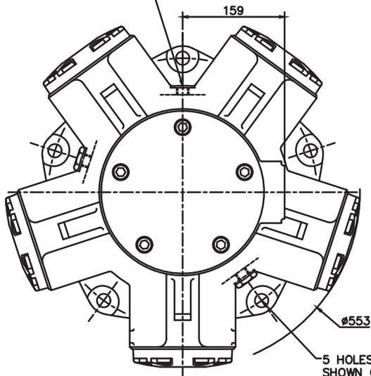
5 HOLES  $\phi 21$  EQUI-SPACED AS SHOWN ON A 419.1 PCD. SPOTFACED TO GIVE AN EFFECTIVE  $\phi 40$
